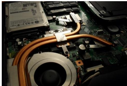
Refroidissement de l' lectronique d'un portable
