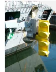
Sonar 2087 sonar actif basse fréquence pour bâtiments de surface
