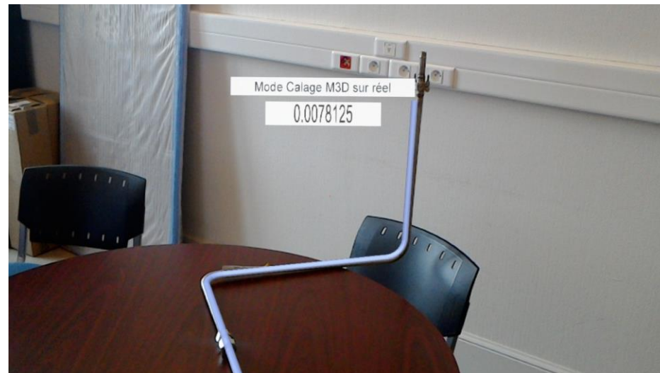
Exemple de calage virtuel sur réel permettant de contrôler si une pièce a des défauts.
